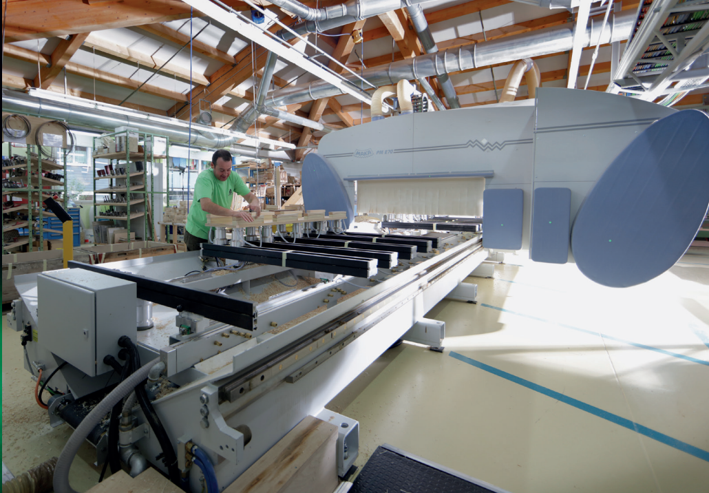
Modernste Technologie: Eine der 5-Achs-CNC-Maschinen
